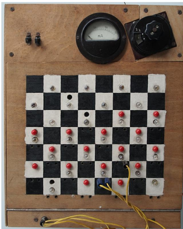
Vorne (unten im Bild) befindet sich eine 3,5cm tiefe und 36cm breite Leiste, die links eine versenkte Buchse für einen 4mm Stecker hat, der den gemeinsamen (Masse-) Pol der drei Kabeln mit 4mm-Steckern hat. Deren Farben sind blau, blau und schwarz; die Farbe ist technisch ohne Bedeutung.
