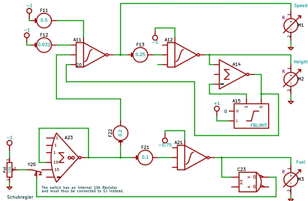
Die Integratoren A11 und A12 liefern die Geschwindigkeit und die Höhe. Ist die Höhe kleiner als Null, liefert A14 ein Signal, dass mit dem Faktor 20 die Fähre zurücktreibt, während sie auf ihren Stelzen federt. Die Beschleunigung am Eingang von A11 setzt sich zusammen aus der Gravitation und dem Schub, der der Gravitation entgegengerichtet ist. A22 simuliert den Treibstoffvorrat; ist der aufgebraucht, wird über A23 der Schubregler abgeschaltet.
