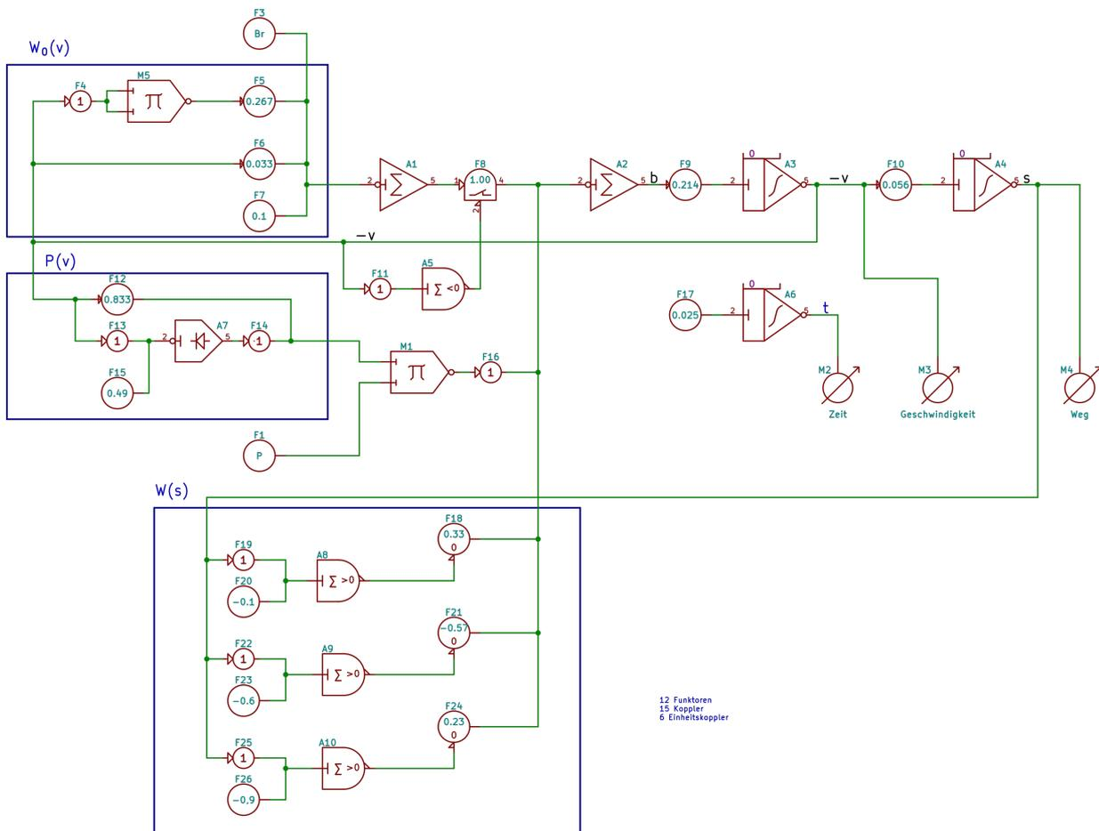
Hier ist der Regler  $P$  immer eine Beschleunigung, und die Funktion  $W_0(v)$  immer eine Verzögerung. Die Funktion  $W(s)$  kann negative Werte ausgeben. Daher ist der Faktor vor dem ersten Integrierer 0.214 und nicht verdoppelt.
