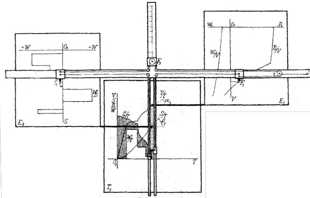
Links ist die Tafel für den Streckenwiderstand; diese Tafel wird von der Maschine senkrecht zum Schieber gemäß dem berechneten Weg verschoben; die rechte Tafel bestimmt in gleicher Art die Zugkraft als Funktion der Geschwindigkeit, und in der Mitte ist eine Trommel (hier als Tafel dargestellt), die in gleicher Richtung wie die Tafeln als Funktion der Zeit verschoben wird und auf der Weg und Geschwindigkeit aufgezeichnet werden.
