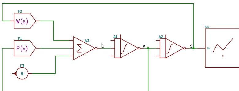
Die Funktionen werden während der Rechnung vom Bediener mittels Schiebern eingestellt; für  $F_1$  und  $F_2$  werden Blätter mit den gewünschten Funktionsverläufen auf Tafeln aufgelegt und die horizontalen Schieber dem Funktionsverlauf nachgeführt, während der Schieber  $F_3$  senkrecht mit einer Skala eingestellt wird:
